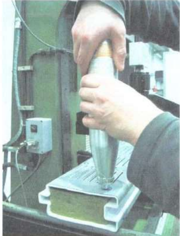
Ek 1.2: Sol resim: Test başında beton için sertlik ölçer kullanıldı. Sağ resim: Test sonunda, beton için sertlik ölçer dişiyile taş çarpma testi ilerlemektedir.
